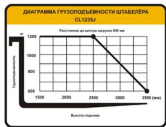
Рисунок. 4. Диаграмма грузоподъемности штабелера.
