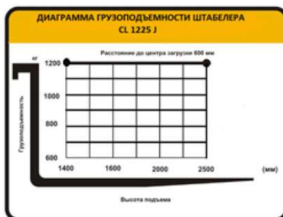
Рисунок. 4. Диаграмма грузоподъемности штабелера.
